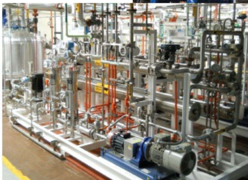
Impianto di concentrazione di un principio attivo farmaceutico
